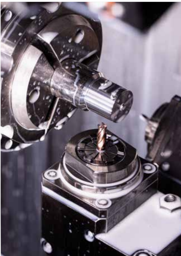
Fräsen der Schlüsselflächen mit dem HORN-System DS.
