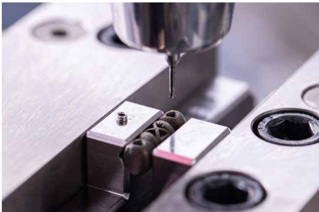
M3-as belső menet marása nyomtatott titán alkatrészben.
