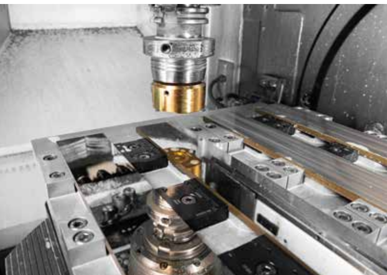
Le fraisage poli-miroir permet d'obtenir une planéité parfaite et des états de surface réfléchissants de l'ordre du nanomètre.
