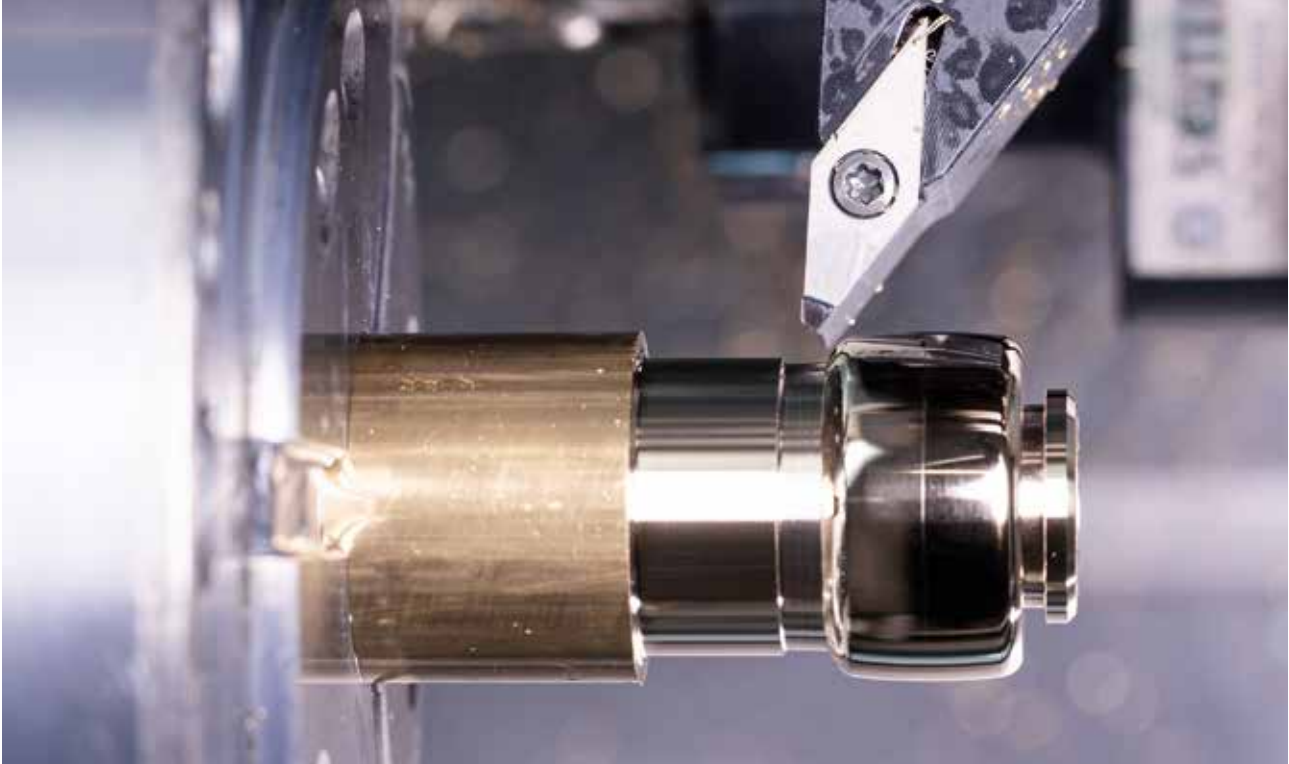
Tournage haute brillance du diamètre extérieur avec une plaquette ISO équipée de MCD.
