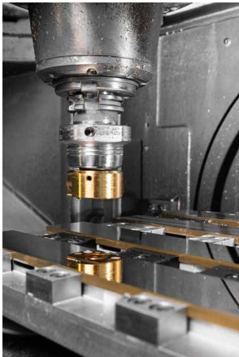
Le fraisage poli-miroir permet d'obtenir une planéité parfaite et des états de surface réfléchissants de l'ordre du nanomètre.
