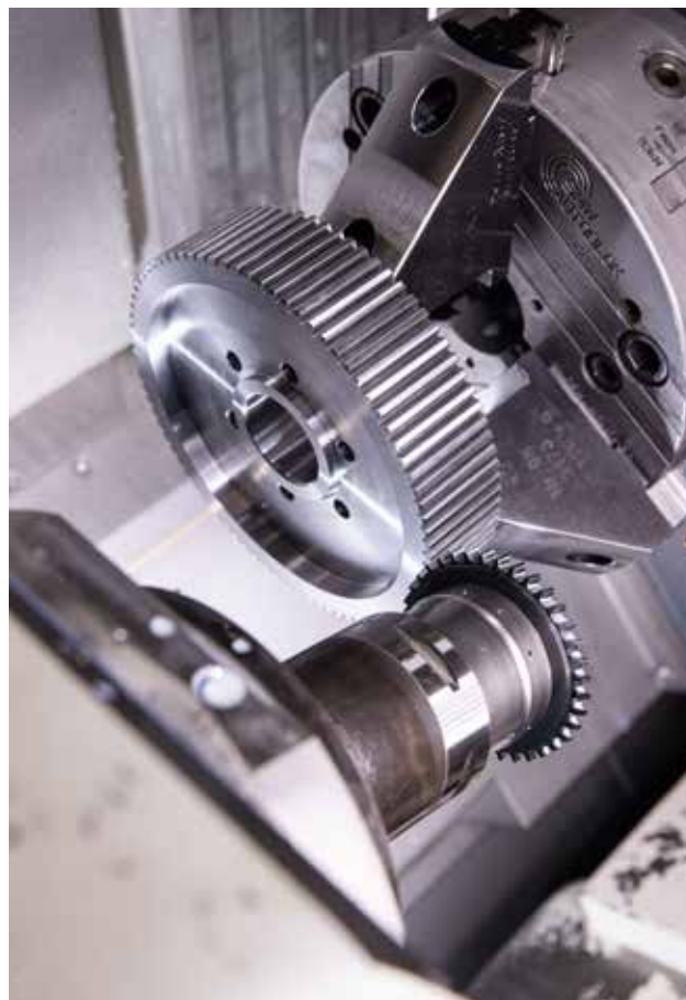
Le porte-disque est utilisé dans une combinaison embrayage/frein.
