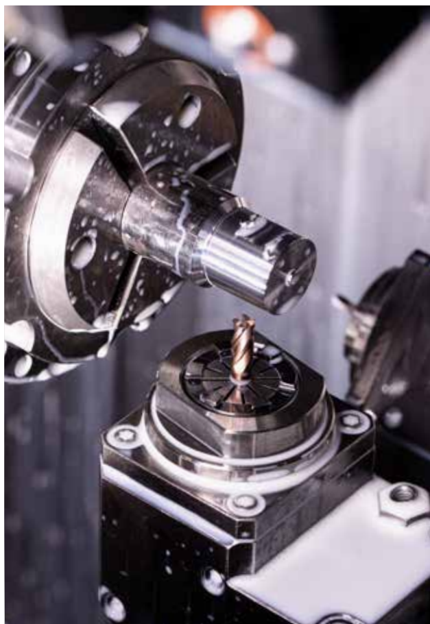
Fraisage des plats de la clé avec le système DS HORN.
