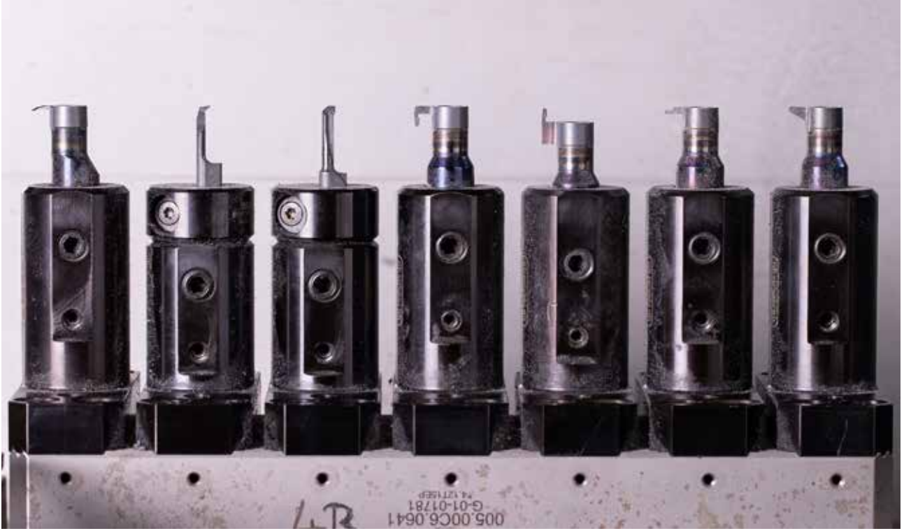
Un outil est monté sur le peigne à outils pour chaque usinage.
