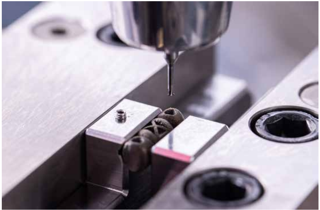
Fraisage de filets intérieurs M3 dans une pièce en titane imprimée.
