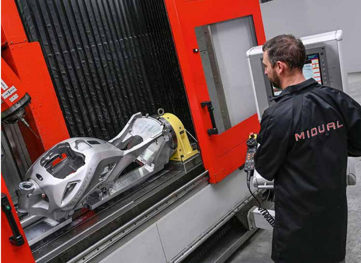
Après la coulée, l'usinage se fait sur un centre d'usinage CNC.
