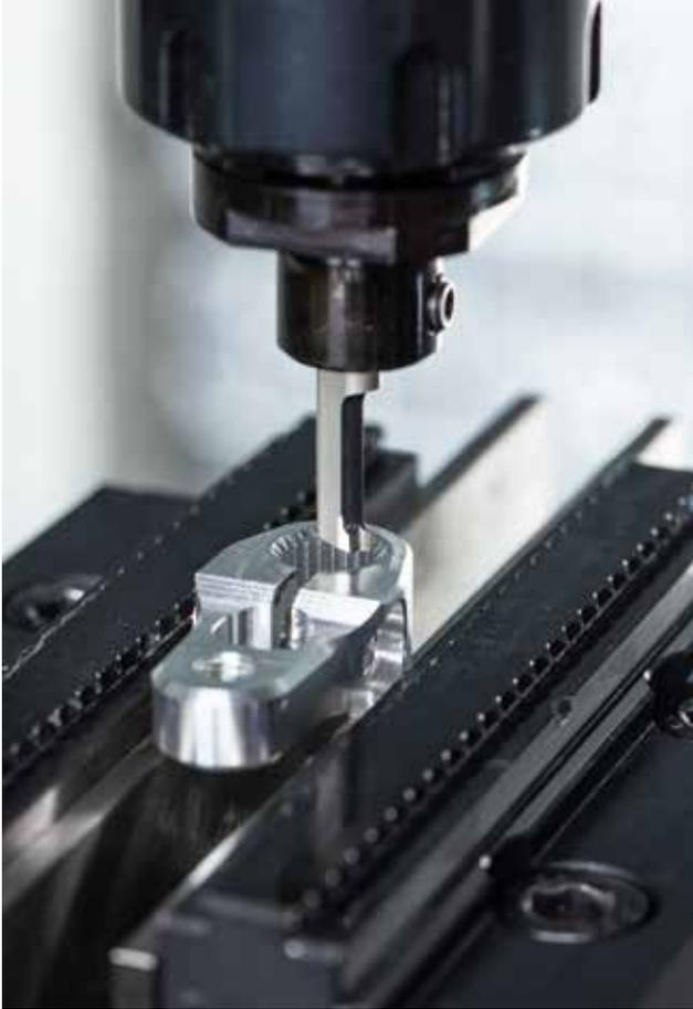
Pour le mortaisage de dentures, Mr Midy mise sur le type d'outil Supermini.
