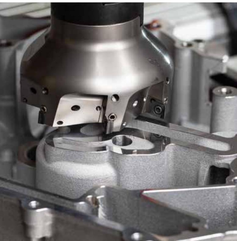
Le système de fraisage DTM de HORN assure, grâce aux inserts de coupe PCD, des qualités de surface élevées sur les composants en aluminium.
