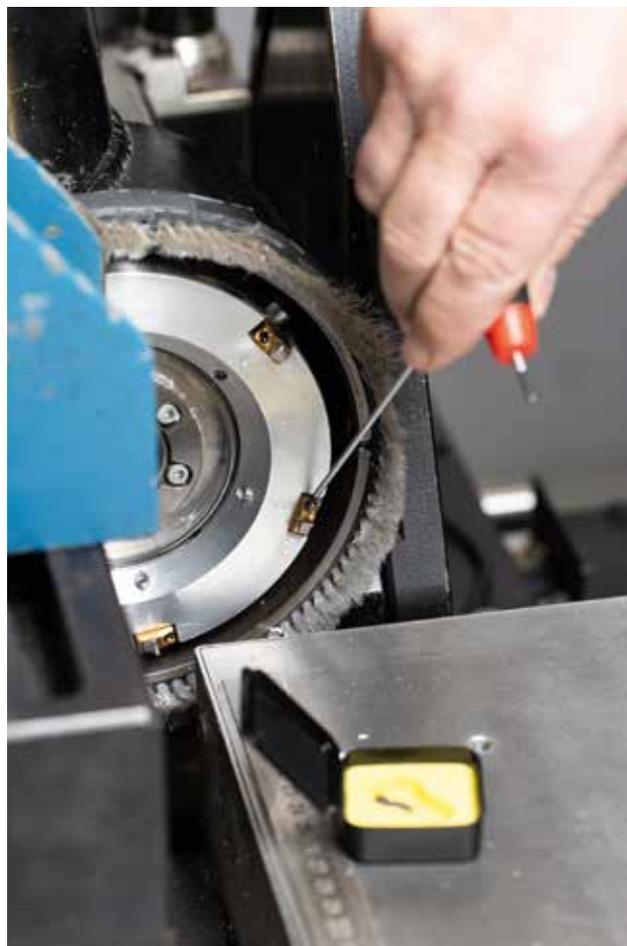
Les plaquettes de coupe se serrent facilement à l'aide d'une vis, sans avoir à démonter la fraise.
