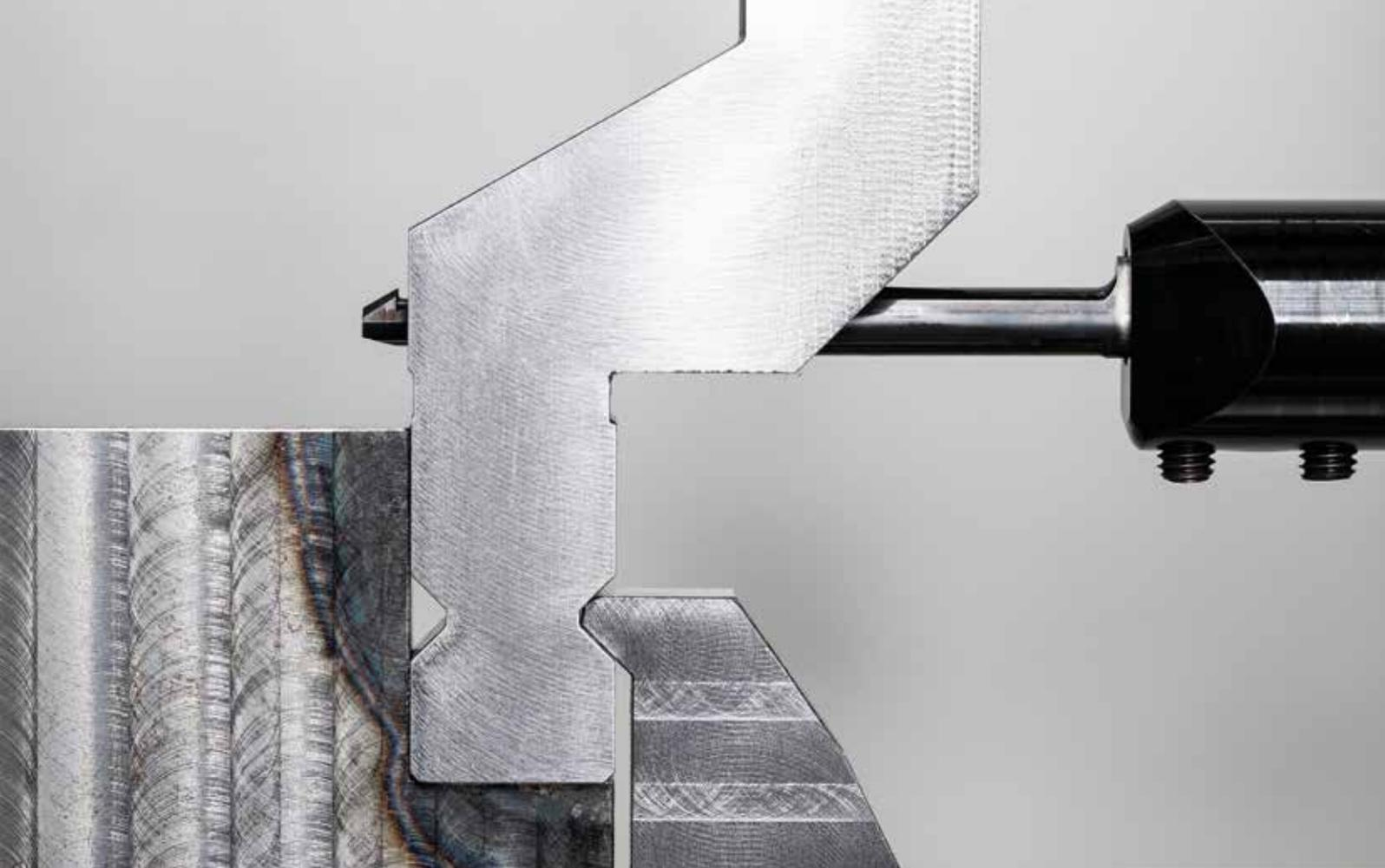
Malgré le long porte-à-faux, il n'y a pas de vibrations lors de l'usinage et les traces de broutage qui en résultent.
