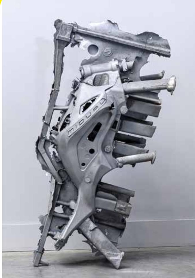
Environ 1.700 kg de sable et une semaine de travail sont nécessaires au sous-traitant pour le moule en sable de 15 pièces du cadre monocoque. Lors de la coulée, 80 kg d'aluminium sont versés dans le moule.
